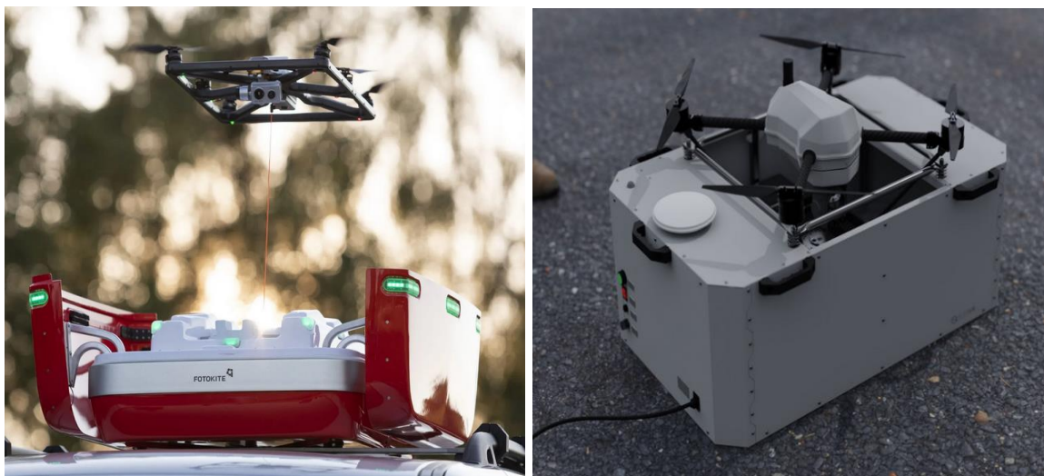
Rysunek 5. Bezzałogowe statki powietrzne do lotów na uwięzi wraz z stacjami dokującymi (od lewej): Fotokite Sigma i Elistair Khronos.
