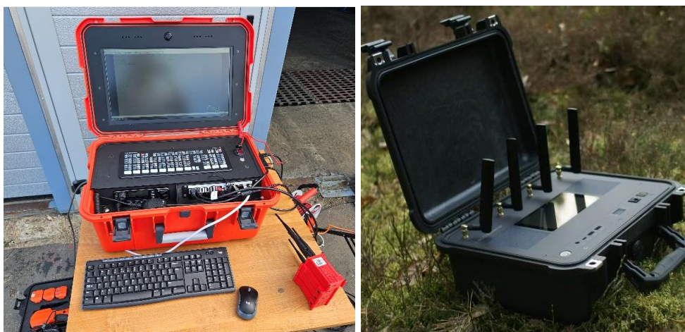
Rysunek 3. Zestawienie wybranych systemów do bezprzewodowego przesyłania danych z BSP w czasie rzeczywistym. Po lewej stronie – Mobilne Centrum Dowodzenia (RPASAR), po prawej – ACO Streamer 4K LTEA (ACO Solutions).
